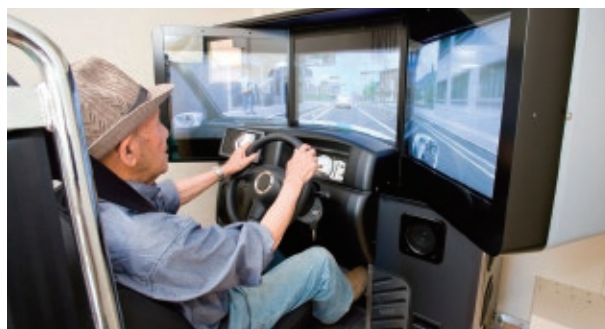
ドライビングシミュレーターを使った安全運転診断の風景
