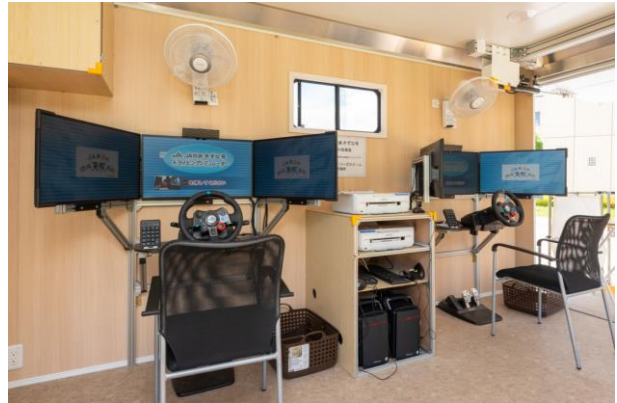
トラック内に設置されたドライビングシミュレーター
