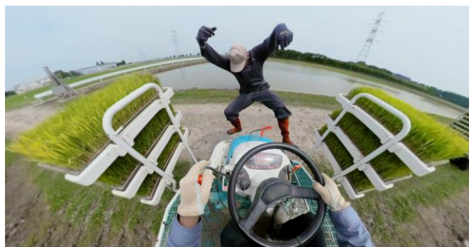
「補助作業者の転落事故」
